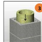
3 Etaler le mortier de pose et maçonner un nouveau boisseau par-dessus l'isolant
