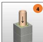
4 Graisser et mettre en place le conduit céramique.
